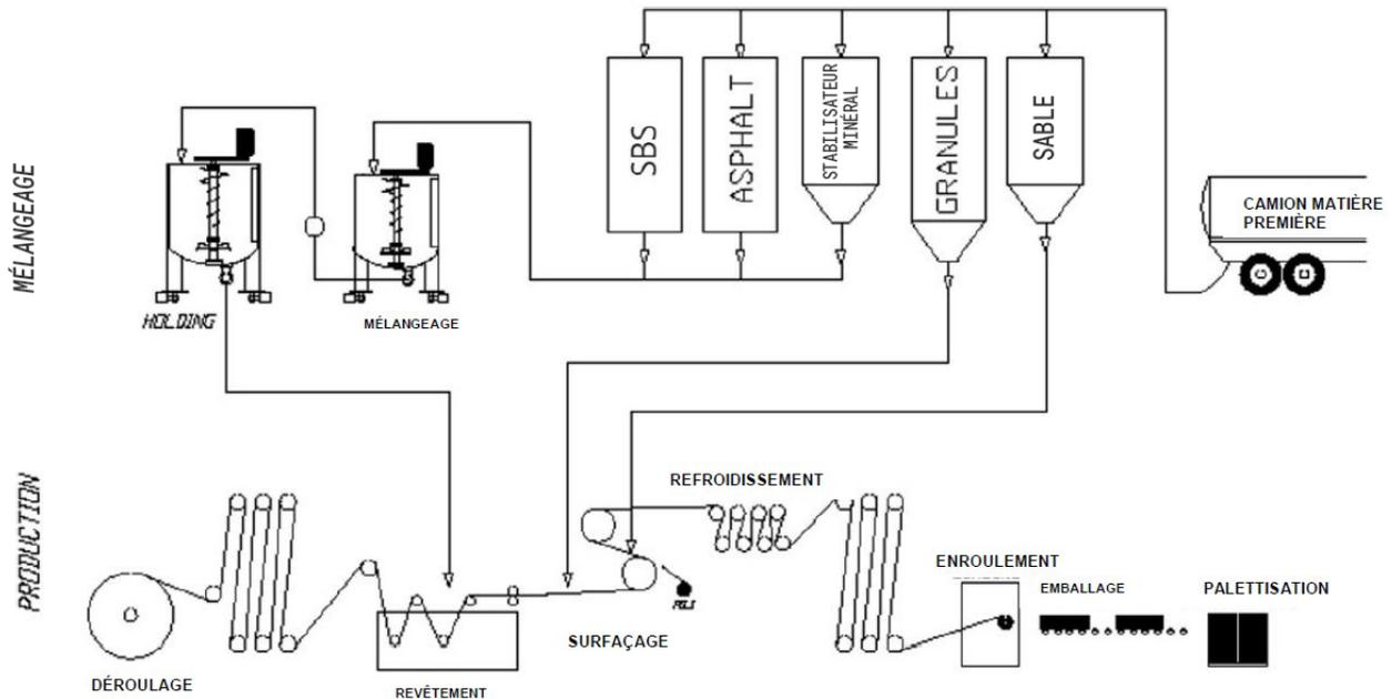
Figure 2 : Diagramme du processus de fabrication des membranes de sous-couche et de finition de bitume modifié au PPA
